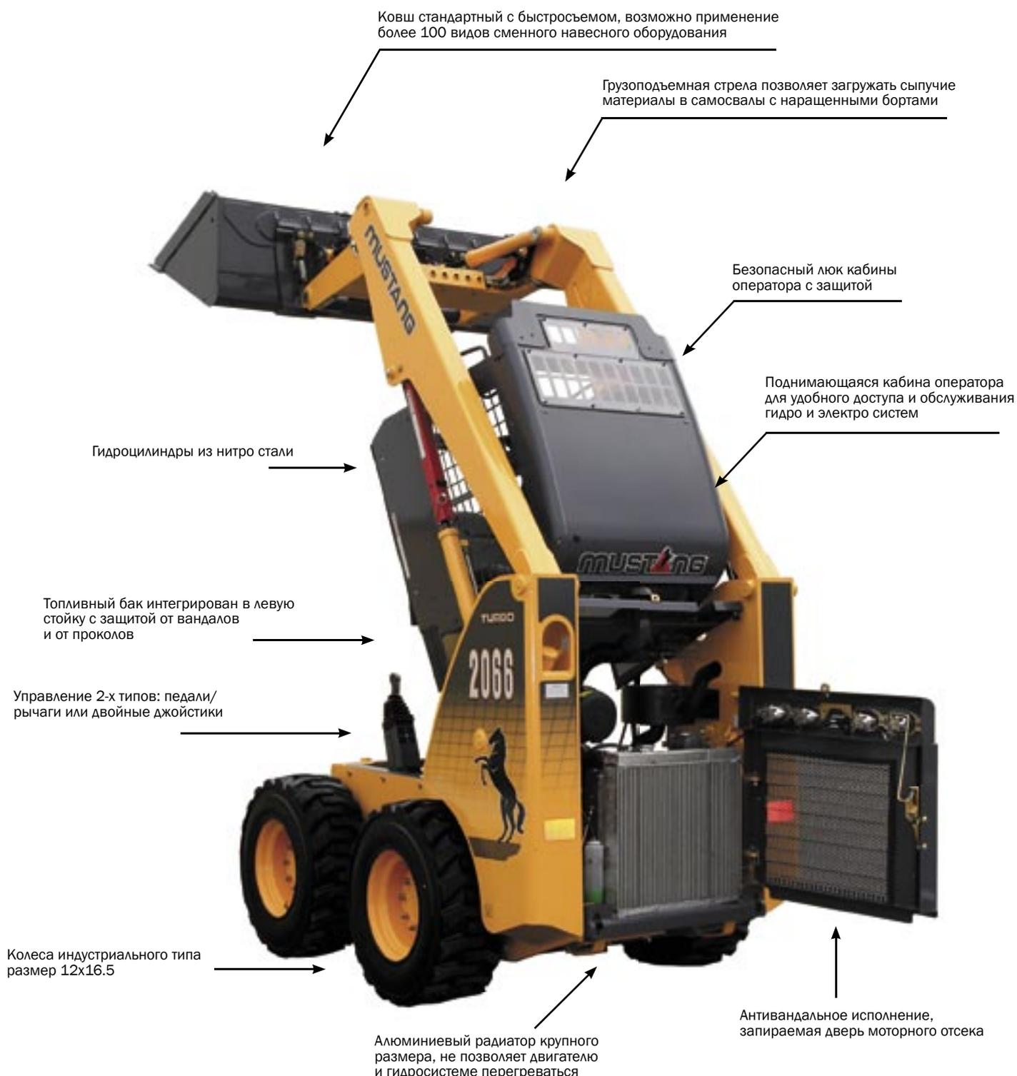
■ Фронтальный вход в кабину со ступенями на ковше и раме и поручни безопасности на стойках кабины
