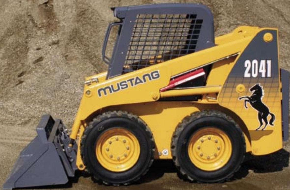
По системе управления мини погрузчики MUSTANG представлены в двух вариантах: педали/рычаги или двойные джойстики. В модельном ряду MUSTANG имеются мини погрузчики со стандартной скоростью передвижения и высокоскоростные модификации (2 speed). Диапазон грузоподъемности составляет от 385 до
