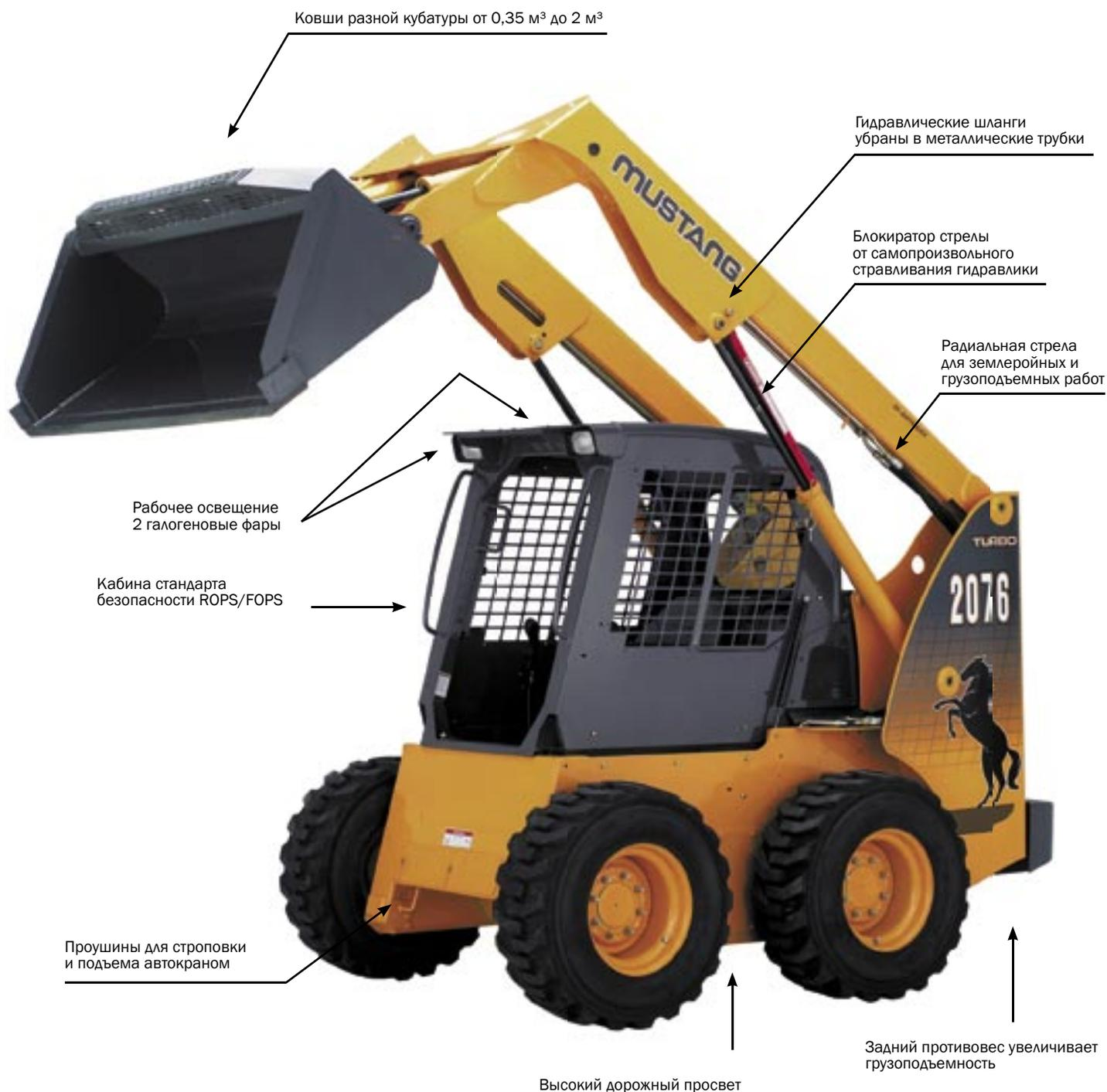
■ Все модели мини погрузчиков MUSTANG поставляются на российский рынок в зимнем исполнении кабины с отоплением и остеклением уже в базовой комплектации
