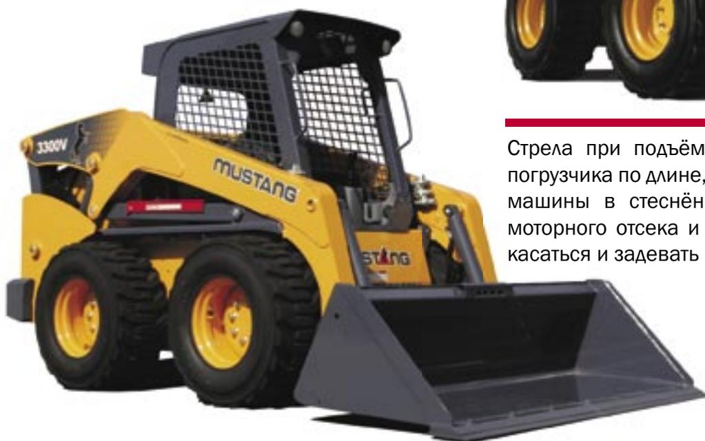
Стрела при подъёме не выходит за габариты погрузчика по длине, что важно при эксплуатации машины в стеснённых условиях, когда дверь моторного отсека и грузовая стрела не должны касаться и задевать стен объекта.
